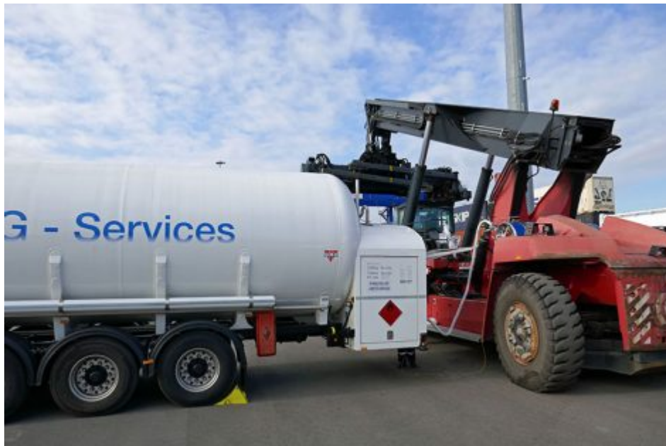
Quelle und Foto: duisport, der Reachstacker wird erstmalig mit LNG betankt.
